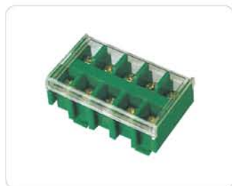
JF5-1.5mm 2 导线截面wire section: 0.5-1.5mm 2 额定电流/电压rated current/voltage: 17.5A/660V 位数Pole:1P、2P、3P、5P 型号item:1.5/1、1.5/2、1.5/3、1.5/5
