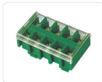
JF5-4mm 2 导线截面wire section: 2.5-4mm 2 额定电流/电压rated current/voltage: 32A/660V 位数Pole:1P、2P、3P、5P 型号item:4/1、4/2、4/3、4/5
