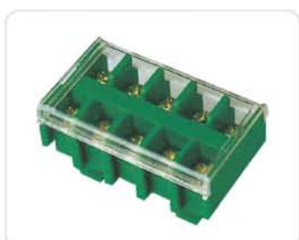
JF5-10mm 2 导线截面wire section: 4-10mm 2 额定电流/电压rated current/voltage: 57A/660V 位数Pole:1P、2P、3P、5P 型号item:10/1、10/2、10/3、10/5
