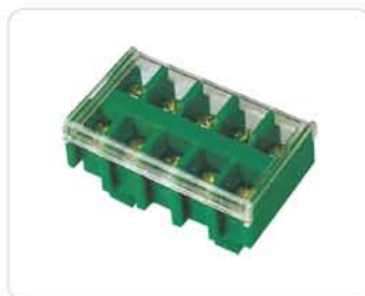
JF5-2.5mm 2 导线截面wire section: 0.5-2.5mm 2 额定电流/电压rated current/voltage: 24A/660V 位数Pole:1P、2P、3P、5P 型号item:2.5/1、2.5/2、2.5/3、2.5/5
